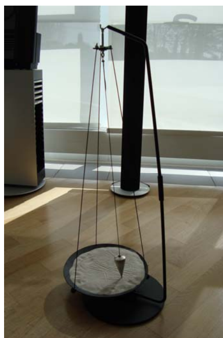
Εικ 2. Το μικρό εκκρεμές που χρησιμοποιήθηκε για τον έλεγχο σχετικά με την επίδραση της περιστροφής του σημείου εξάρτησης στο επίπεδο ταλάντωσης του εκκρεμούς.
